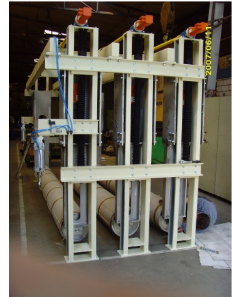
Verfahrbare angetriebene Walzen für variable Streckenlänge für ein Nachbe- feuchtungsbecken der PE-Folien Herstellung.
