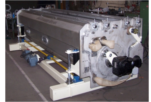
PE- Folien Kühlbad mit angetriebener Kühlwalze. Kühlbad verfahrbar und höhenverstellbar. Werkstoff 1.4571
